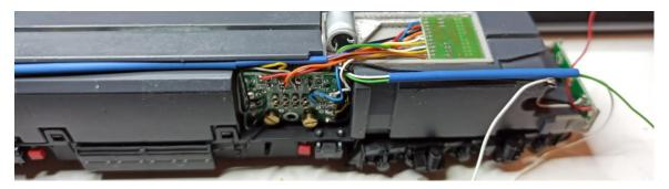
Tal como se ve en el montaje de la foto de arriba la locomotora funcionaría como en el capítulo 1, aunque cambiando F0f/F0r por AUX1 y AUX2. En este caso los cables verde y violeta serían las luces rojas delantera y trasera, conectados a AUX3 y AUX4.
