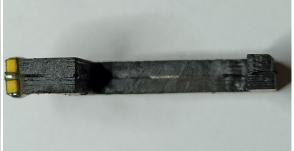
Vista la pieza de frente y de perfil hace esta forma. Los cantos se pintan de negro para que no se vea por la cabina la pieza y, especialmente para evitar contactos con el chasis metálico, incluso se podría biselar un poco para evitar que quede cerca del parabrisas. Esto lo dejo a gusto del lector. El único retoque que le hice fue biselar la parte superior de los leds para que no topara con el techo.
