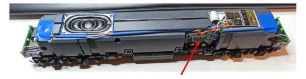
En la parte de la carrocería los cables de hilo esmaltado los he pegado al techo con cinta aislante como se ve en la foto.
