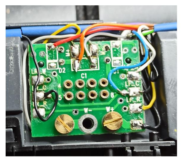
Como se puede ver en la foto, por contraposición con la foto el capítulo anterior, para poder soldar los cables de la vía y del motor he quitado tres componentes de la placa, que tampoco son necesarios, dos diodos D1 y D2 y un condensador C1.
