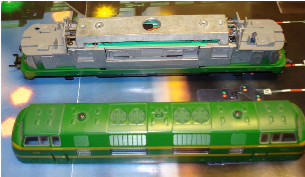
En la parte interna el chasis está partido en dos partes, la principal que sujeta todo y una especie de tapa metálica que se sujeta con dos tornillos, uno a cada lado de la placa de control a la que envuelve. El motivo es evitar que la luz de las bombillas traspase la carrocería.
