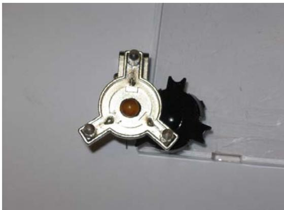
En la carrocería hay dos piezas metálicas (como la de la foto de la izquierda) con sendas bombillas que alumbran a los 3 focos por lado que tiene la locomotora. En principio se han cambiado las bombillas por leds blancos de 5 mm. pintados de laca amarilla para evitar que quede la luz algo amarillenta (algunos utilizan Betadine para enmascarar la luz blanca).
