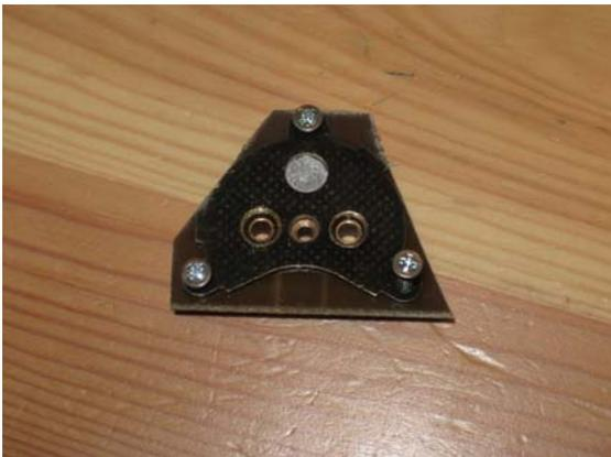
En la foto de la izquierda se ve la tapa por el lado contrario. En este caso hemos puesto la placa metálica que llevaba anteriormente el motor para reproducir la forma exterior de la misma. Como no se puede hacer por el lado de las pistas se ha de hacer por el otro lado.
