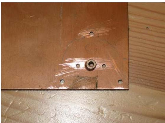
Sujetando entonces con los tornillos ambas piezas hice el agujero central en la misma medida que tiene la tapa. A ambos lados del agujero central se hacen los dos agujeros de los cilindros portaescobillas. En mi caso los hice de pequeño tamaño y luego fue comiendo lentamente con la lima hasta llegar al tamaño ideal del agujero.
