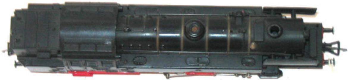
Una vez desprendida la carrocería metálica se puede quitar el contrapeso intermedio y quitar el cable de las luces, solidario a una especie de diodo que va alojado en la parte trasera del motor sujeto por una pletina que se sujeta en dos ranuras al chasis.
