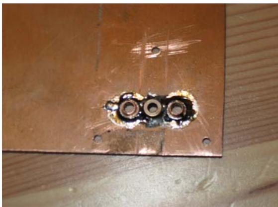
Una vez terminado esto ya podemos comenzar a soldar en la placa las tres piezas que van en esos agujeros. La primera, por ser de latón tendría que ser el cojinete del eje del motor. Con ésta es especialmente significativo que se ponga totalmente plana, y se verifique la perpendicularidad del eje del motor. Posteriormente se sueldan los dos cilindros de cobre, que tienen un resalte que ha de apoyar en la placa.
