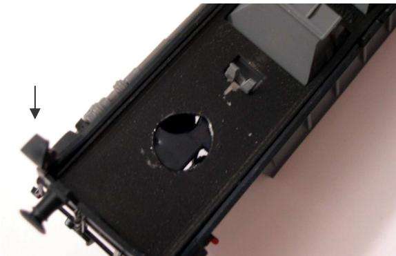
Amb el mini trepant i un disc de tall, fem un encaix en les pestanyes que subjecten la *tolva* al xassís. Aquest encaix a d'ésser prou ample per que passi la peça que subjecta la molla que fa el retorn de l'enganxament. També retallarem, per la seva cara interior, les peces que fan d'escala d'accés a la passarel·la de frens del vagó i, per l'extrem oposat, als ancoratges d'aixecament del vagó, de manera que no es noti per la cara exterior. (Peces assenyalades amb la fletxa).
