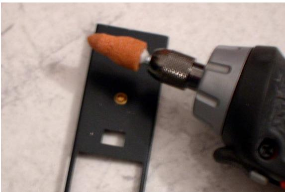
Per poder treure els pivots que fan de suport dels *bogies* antics, necessitarem llimar-los per la part superior, dons estan reblonats. Per fer aquesta operació utilitzarem un mini trepat amb una broca que faci de mola i rebaixarem la peça fins a deixar-la a nivell del xassís, com es mostra a la imatge.
