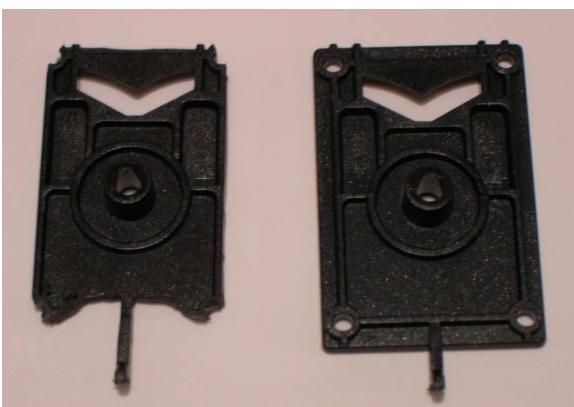
Ara tenim que treballar amb les peces que fan de suport als nous *bogies*. La imatge de la dreta la mostra en el seu estat original, i la de l'esquerra, la manera com ha de quedar. Per això utilitzarem un cutter o el mini trepant. Tindrem que anar amb compte per no tallar la fina i llarga peça que te que subjectar la molla de retorn de l'enganxament.
