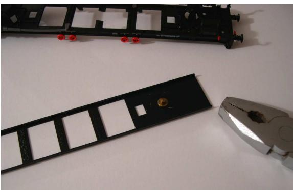
A continuació, amb unes alicates, i per la banda de sota del xassís, estirem del pivot fins a treure'l del seu lloc.
