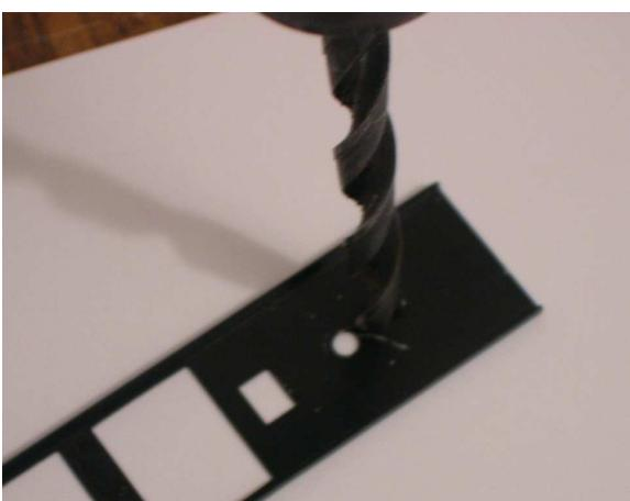
Ara, amb el trepat i una broca per metall (jo he utilitzat la de 8 mm.), tenim que fer un forat just al costat del que ha quedat al extreure els pivots i per el costat mes proper a l'extrem del xassís, de manera que el forat vell i el nou quedin units i en línia.
