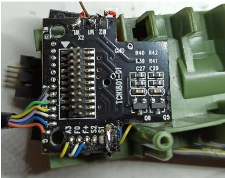
Entre unas cuantas soldaduras algo deficientes podemos encontrar que S1 y S2, que son los terminales a los que se conectan los cables del altavoz no tienen soldado ningún cable.
