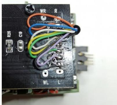
En la foto de la izquierda se puede ver que con la simple realización de un lazo sobre la placa y soldando al revés en los pads se nos han quedado los cables bien ajustados y la placa de iluminación se puede alojar perfectamente en su lugar.
