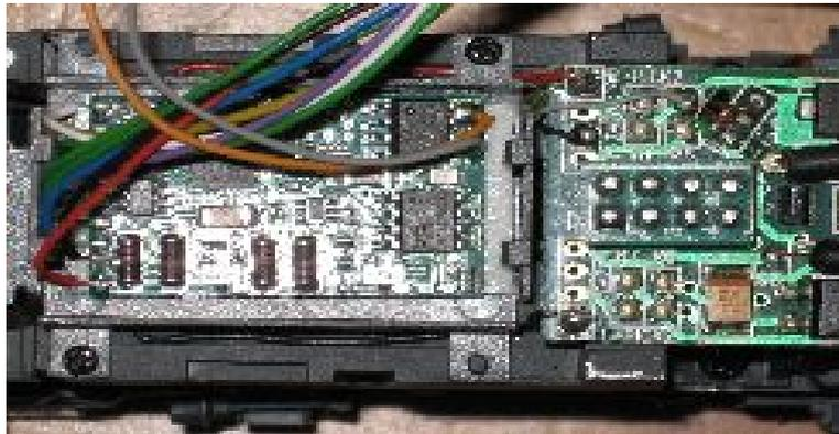
Una vez pegado el descodificador haremos un mazo con los hilos del descodificador. En este caso el descodificador tiene 3 cables de función verdes y uno violeta, se pueden desoldar de la placa y nos evitamos otro paso posterior o simplemente cortarlos más adelante y dejarlos inhabilitados. Aunque en la foto de arriba no esté el anillo que hemos hecho con tubo termoretráctil, se puede ver ésto en la preparación del descodificador (foto de la página anterior lado cara).
