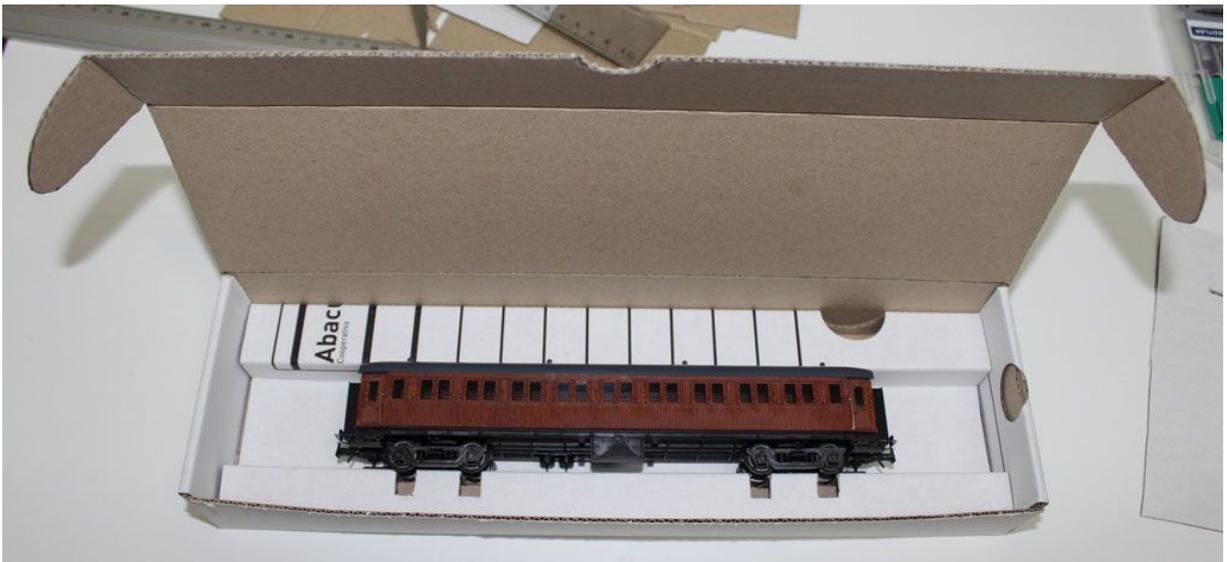
Por último se pueden hacer 4 inserciones (recortando el cartón) para que se ubiquen las ruedas, y así evitamos que el vagón se mueva de lado. Si se quiere se podría poner algún tipo de material aislante o almohadillado para evitar que el vagón pueda volcar sobre la solapa superior.
