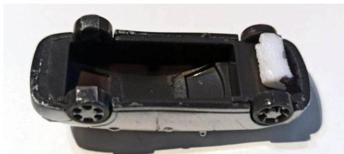
En la foto anterior se pueden ver dos formas diferentes de pegado, una en la derecha bajo el bloque motor, que es un pequeño fondo plano y otra en la parte posterior que cae sobre las ruedas, que evita que el coche bascule hacia arriba.
