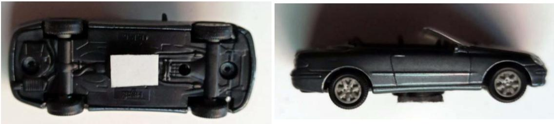
Como se puede ver, la cinta adhesiva lleva un grosor suficiente para evitar el apoyo de las ruedas del coche, y para evitar su visibilidad se camufla con el color negro (un rotulador ya basta) o del color de fondo del vagón. Esta forma deja el coche bien anclado al vagón y a su vez se puede desenganchar fácilmente del mismo sin problema.
