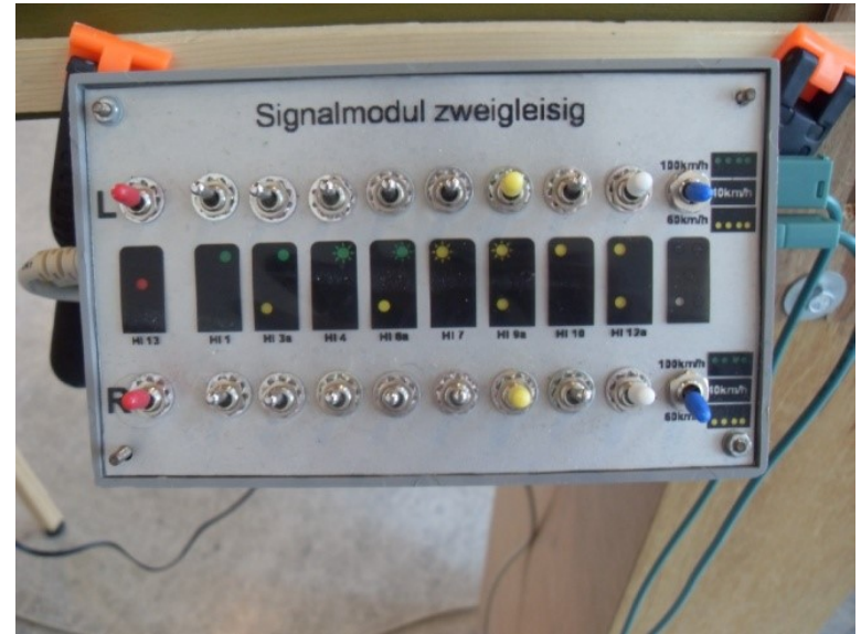
Panell per al control de 2 senyals lluminosos.
