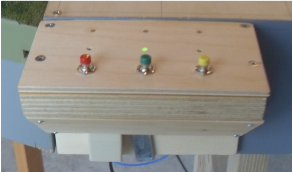
Panell per al control d'un senyal mecànic.
