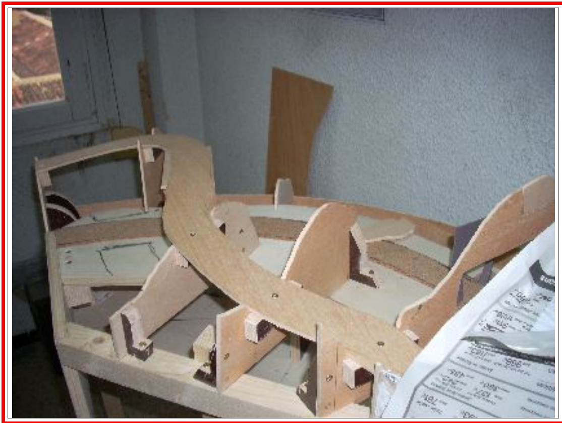
Lecho definitivo de la carretera en panel.
