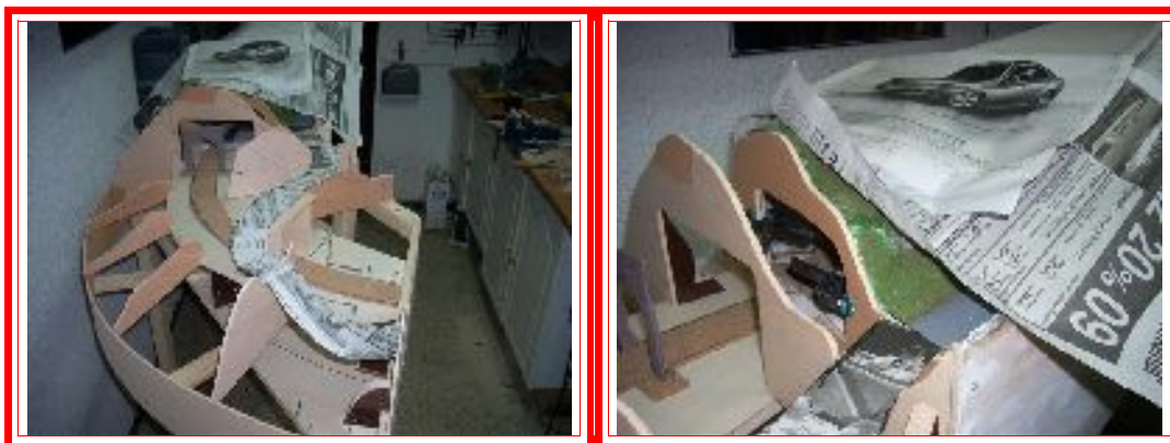
Cuadernas que soportarán el relieve. Alineación con el módulo contiguo.
