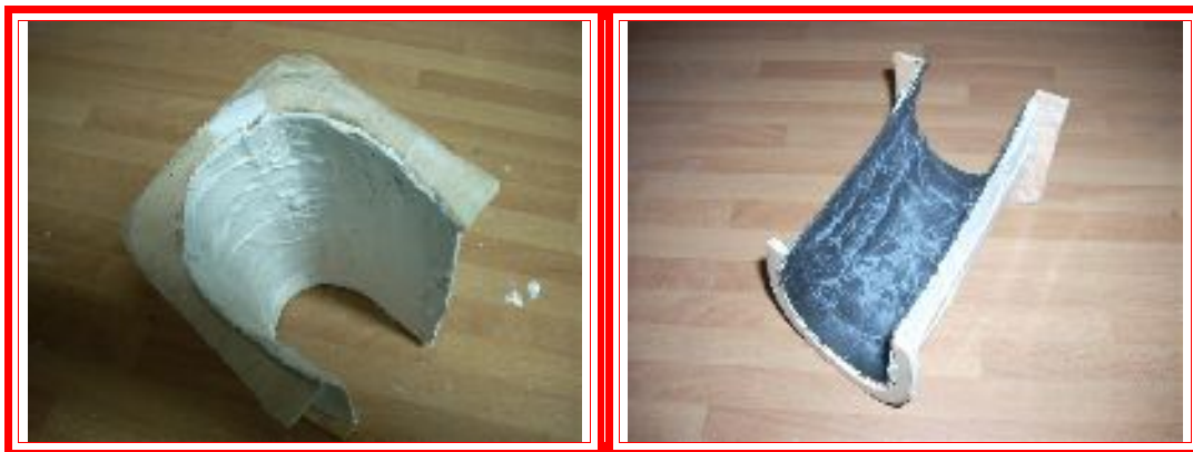
Recubierto con yeso y pintado en negro mate.
