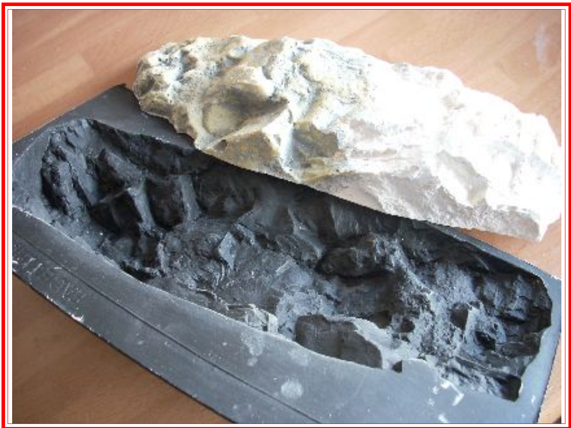
Molde y roca ya desmoldeada
