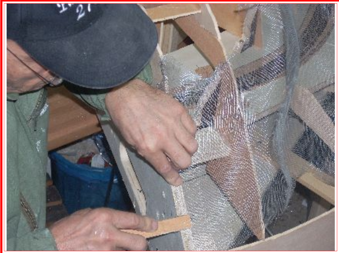
Aplicación y "secado" de la cola caliente.
