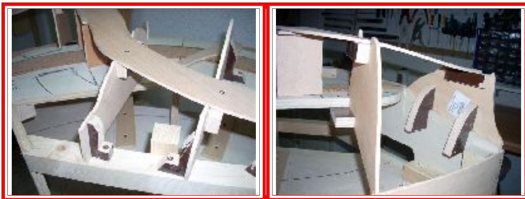
Sujeción de las cuadernas a la base con tacos, según pide el montaje.
