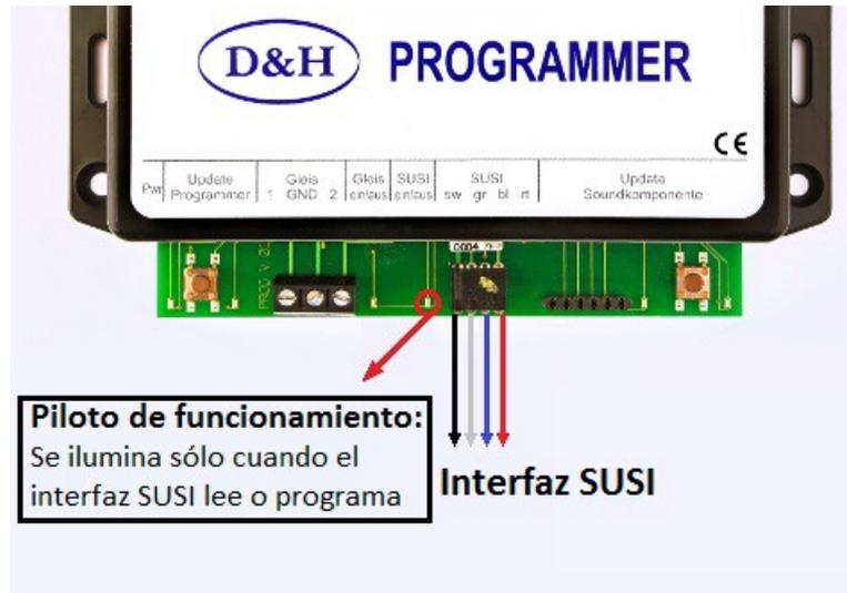
El cableado se realiza en los módulos como para la actualización, y en los descodificadores con la ayuda de un interfaz especial para ello en los descodificadores.
