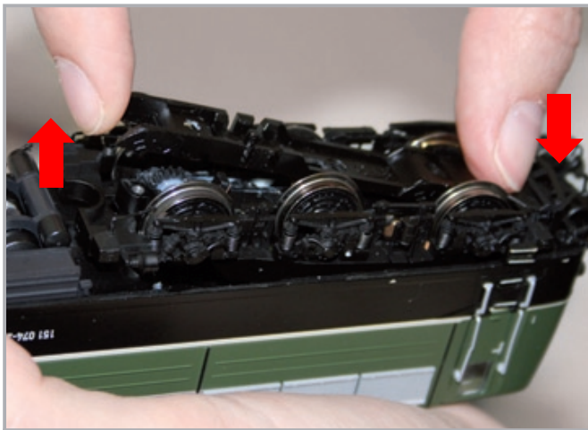
Figura 13: Como retirar el receptáculo de la transmisión
