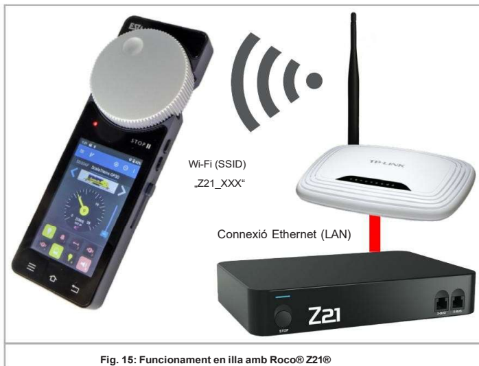
Fig. 15: Funcionament en illa amb Roco® Z21®
