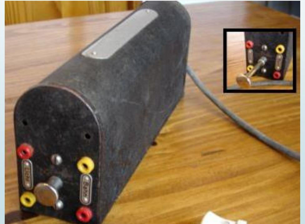
Derecha Transformador de 20 voltios. Wiki. Se puede ver el sistema de conmutación.
